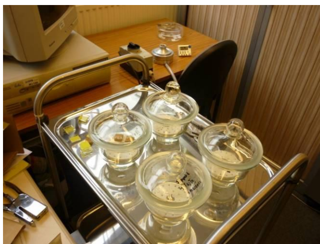
Photographie 7 : Eprouvettes disposées dans les dessiccateurs
